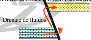
Actividad tectónica: por otra parte, las fallas o plegamiento de las rocas, debido a la fuerza de levantamiento, pueden conducir a sobrepresión, a causa de la actividad hidrodinámica y la modificación y redistribución de los fluidos y las presiones.
