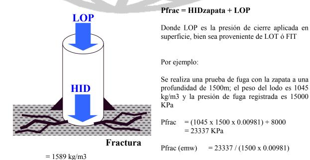
El ingeniero a cargo del análisis de presiones debe saber que, si bien la prueba de fuga es la única manera de determinar la presión de fractura, existen ciertas circunstancias que pueden conducir a imprecisiones o falta de confiabilidad: -
