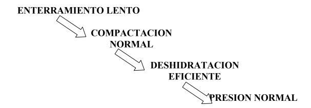
Sin embargo, si no se producen la compactación y deshidratación normales, entonces se puede generar sobrepresión como resultado de la retención de fluidos en los sedimentos .
