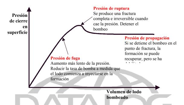
Durante la prueba de fuga, la fractura es realmente inducida por una combinación de dos presiones: -
